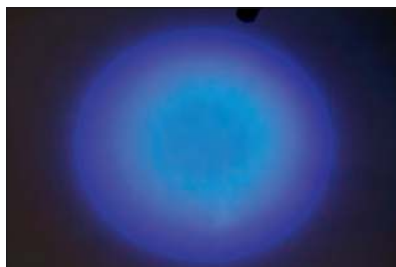
Обычный светодиодный фотополимеризатор излучает голубой свет чаще всего в спектре 430-480 нм.
