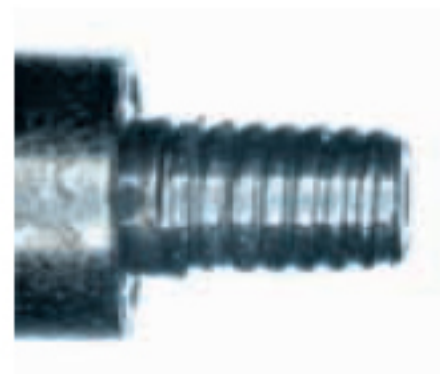
ПОВРЕЖДЕННЫЙ → Типовые ультразвуковые инструменты перегружают сонотрод и резко сокращают срок его службы
